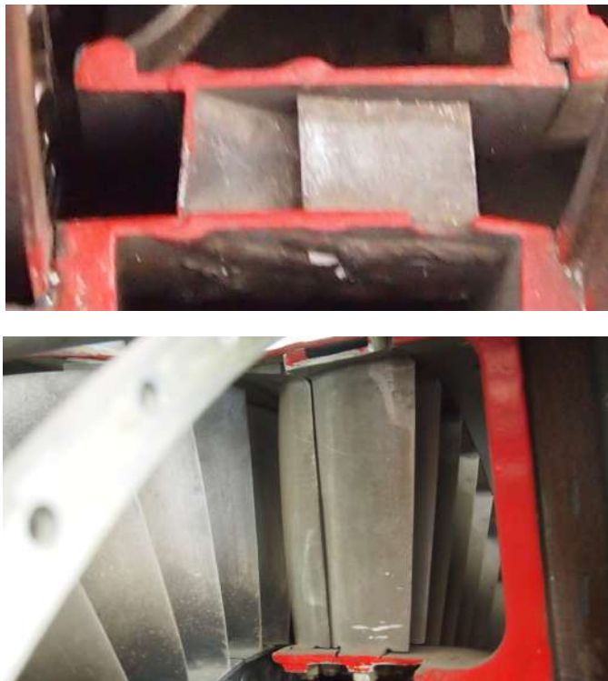
Рис. 1.3. Застосування дворядних лопаткових вінців у елементах статора осьового компресора
