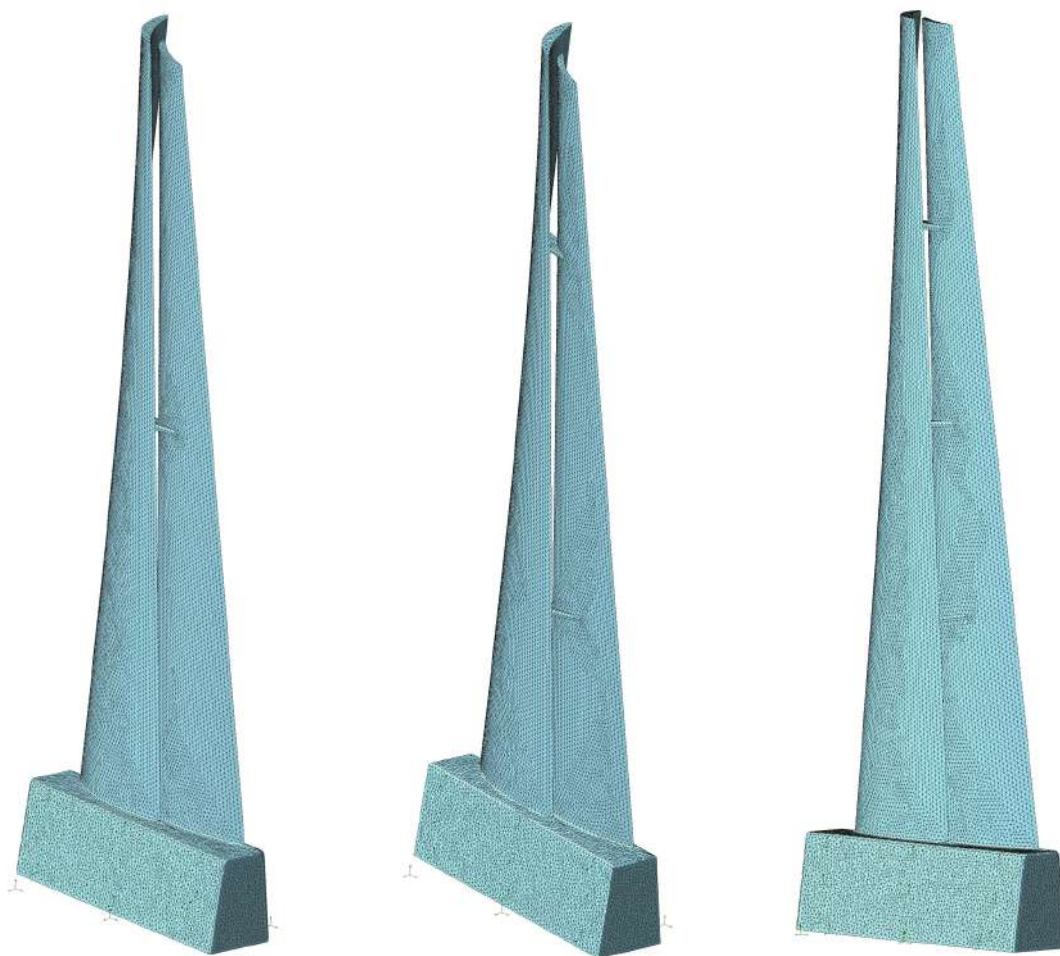
Рис. 4.4. Розрахункова сітка для досліджуваних решітчастих дворядних лопаток
